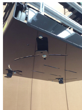
Vista della vaschetta inferiore porta proiettore e dei possibili sistemi di fissaggio
